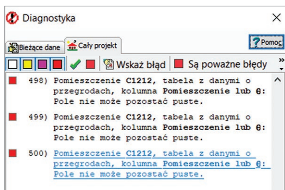
Rys. 7. Błędy uniemożliwiające wykonanie obliczeń importowanego modelu
